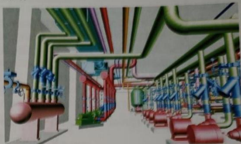
图1 管线碰撞检查(图片来源:作者自绘)
